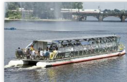
Emissionsfrei über die Alster schippern: Die „Alstersonne“ der ATG Alster-Touristik ist ein besonders schöner Solarkatamaran. Außerdem gibt es die „Alsterwasser“, das weltweit erste im Linienverkehr eingesetzte Fabrgastschiff mit Brennstoffzellenantrieb
